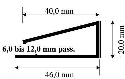
Endprofil für obige Winkel oder Profile und Platten von 6,0 mm bis 12,0 mm
