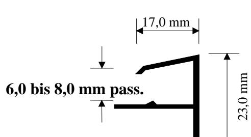
Bei Verwendung obiger Winkel als Leibungsverkleidung dient dieses Profil als Befestigungselement am Fenster! Die Aufnahmenut ist pass. für 6,0 mm bis 8,0 mm Profile oder Platten!
