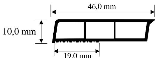
Art.Nr. 0784610 Kammerprofil trapezförmig mit SK
